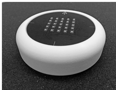
筆者がNUSに在籍していた際に開発したセンサシステム 気圧の傾きを計測することで、気象の変化や換気の可視化が可能。
