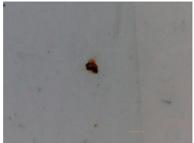
図4 コンテナにできた錆
