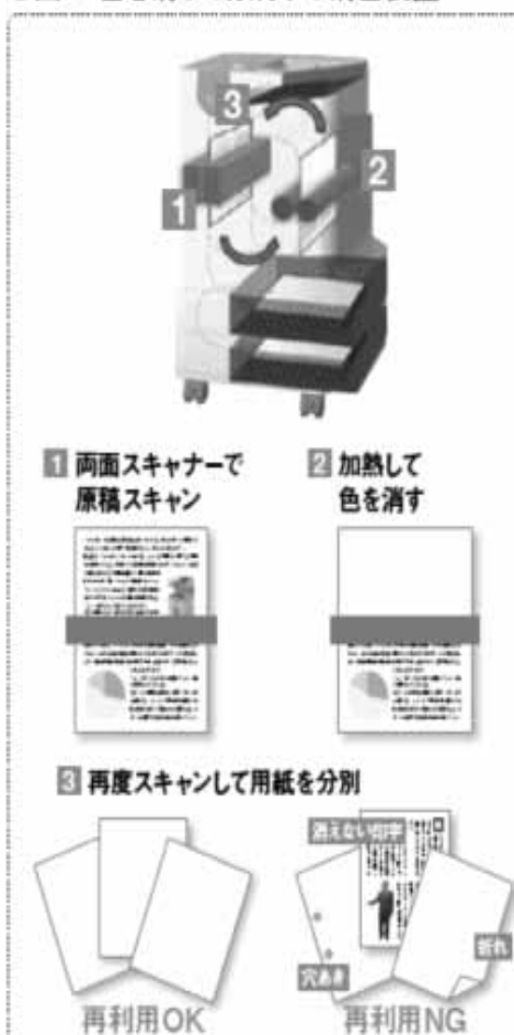
●図2 色を消して分別する消色装置
