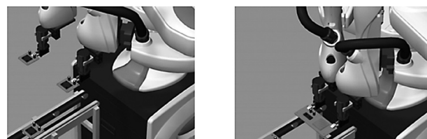
図10 基板チャッキング事例
