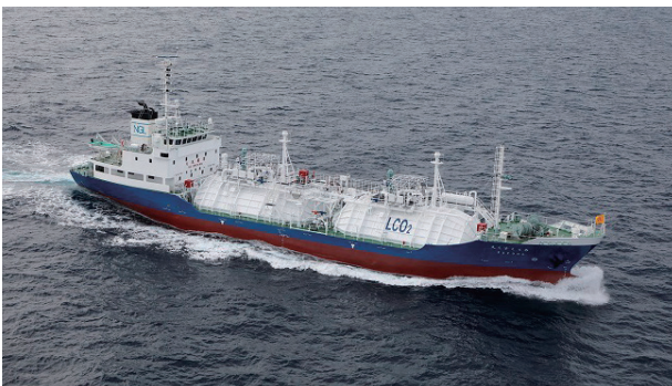
世界初、低温・低圧の液化CO 2 大量輸送に向けた実証試験船「えくすくうる」
