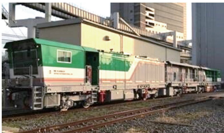
図2 レール削正用のメンテナンス用重機械
